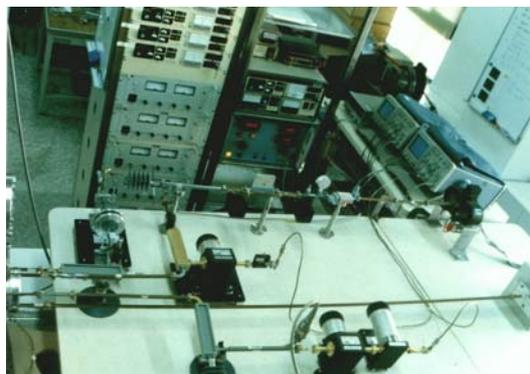
圖四、毫米波診斷系統
